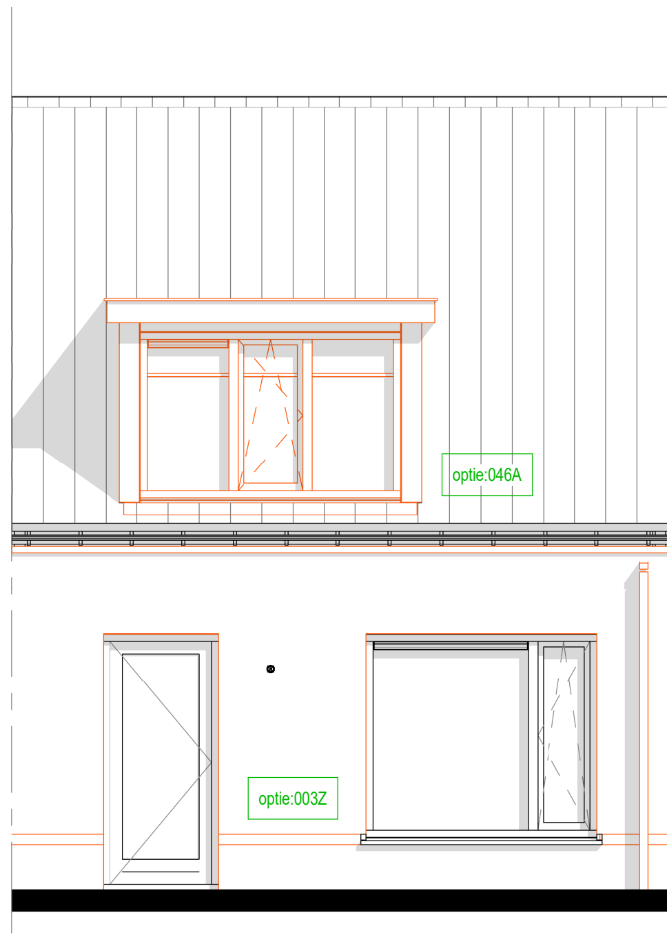
003Z : Uitbouw achtergevel 2400 mm 046A : Dakkapel op achtergevel, breedte 2500 mm - positie 1
